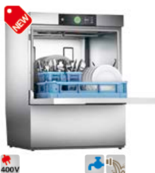
61341 Hobart afwasmachine Premax FP voor spoelkorf 50x50cm 3 programma's (80/240/360 sec) (H/B/D) 83/60/60cm aansluiting 400V/6,8kW/16A CEE incl. set voor 1e vulling
